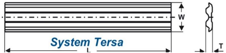
**Caractéristiques:** couteaux à raboter de system Tera en différentes types de l'acier et en carbure, de moyenne dureté, de haute ténacité et résistance à la flexion, destiné pour bois dur et tendre.
