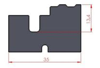
**Application:** plaquettes profilées en carbure de type Leitz pour usage universel, pour bois naturel, outillage de fenêtre.
